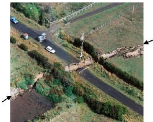
شکل (2-2): پهنه گسل ادج کومب (Edgecumbe) در نیوزیلند در زلزله 1987 (Kerr et al, 2003)
