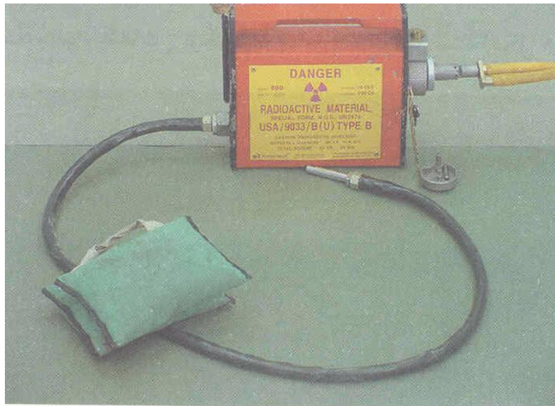
شکل ۳- استفاده از کیسه ساچمه سربی جهت حفاظ پرتوهای ناشی از منبع پرتوزا که در لوله هدایت گیر کرده است
